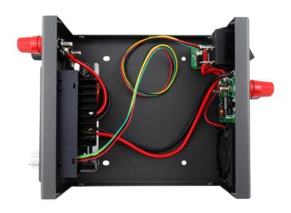
3.4 延伸应用扩展:客户可在壳子内部中间部分装入 10 节 18650 串联的电池组给电源供电,做成手持移动大功率直流稳压电源
