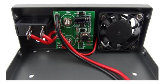
● 将风扇电源线焊接到风扇供电板正面左下方的 5V 焊盘上 (注意正负极不要焊反)。
