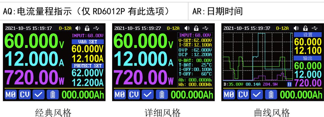
主界面按动 ◀ 或 ▶ 键可以在经典风格、详细风格、曲线风格中切换，曲线风格下，旋转编码电位器可以缩放曲线纵坐标，按动 ENTER 键可以开始或暂停曲线显示；主界面调整风格状态后不记忆，如需设置默认启动界面风格请前往 1.5.2.6 主界面风格设置。
