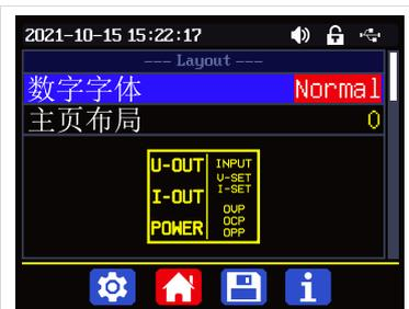
选项，旋转编码电位器改变数值，改变后立即保存更改，请不要设置错误的日期。使用 PC 上位机和手机 APP 可以手动同步时间，详见完整版说明书中上位机和 APP 中联机部分。
