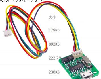
驱动程序安装完成后，通过连接线将通信小板与数控电源连接，并通过 Micro USB 数据线连接电脑。驱动安装成功后在“此电脑”上点击右键，然后点击“管理”“设备管理器”在右侧窗口点击“端口”处的下拉箭头可以看到模块的 COM 端口号（如下图）。
