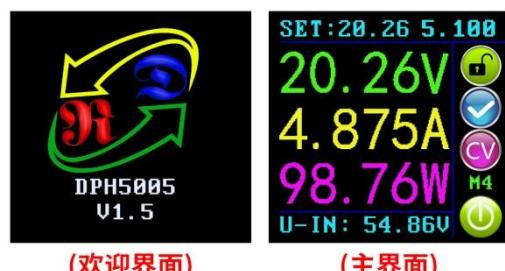
大，逆时针旋转减小。短按 **V/t** 键保存当前设定数据并退出，1分钟内无任何操作会自动保存并退出快速设置；同理通过 **A/t** 键可快速设定输出电流值。
