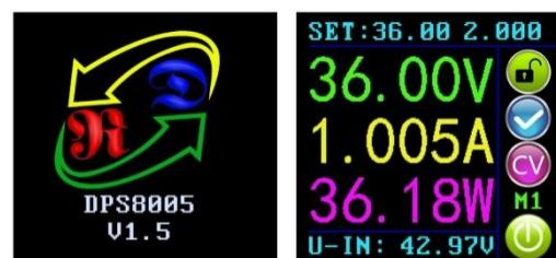
短按 **V/↑** 键，可进入快速电压设定状态，此时按动编码电位器，可逐位循环切换选中电压数字，当数字被选中时，转动编码电位器可以改变数字大小，顺时针旋转增大，逆时针旋转减小。短按 **V/↑** 键保存当前设定数据并退出，1 分钟内无任何操作会自动保存并退出快速设置；同理通过 **A/↓** 键可快速设
